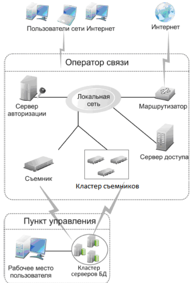
Рисунок 1 Схема подключения АПК «NetBeholder»
